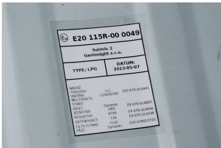
Ukázka typového štítku homologované přestavby dle EHK 115 (zdroj: TÜV SÜD Czech s.r.o.)
